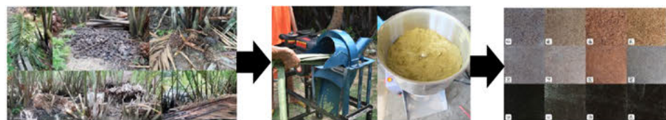
แสดงขั้นตอนการทดลองในการแปรรูปวัสดุเหลือทิ้งจากในส่วนต่างๆ เป็นแผ่นตัวอย่าง
