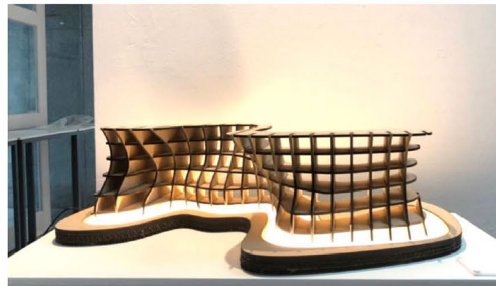
ภาพของหุ่นจำลองในการทดสอบการประกอบและติดตั้งแผ่นไม้ที่ถูกตัดจากเครื่อง CNC
