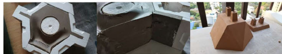
ปัญหาการถอดแบบพิมพ์ 6 เหลี่ยม และการแตกร้าวและบิดงอของด้วย
